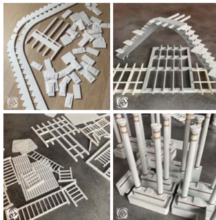
Assemblage des pièces imprimées en 3D et mise en peinture des différents éléments du plongeoir ©LeMog3D
