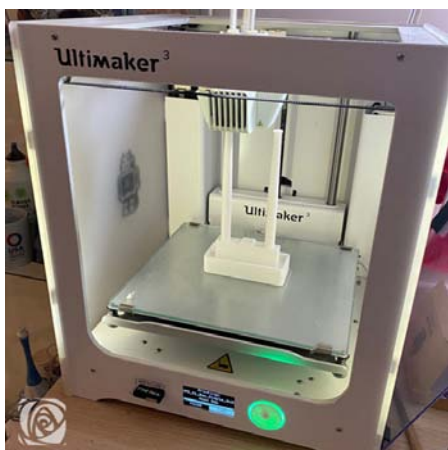
Impression 3D en cours des colonnes jumelées en PLA (bio-plastique fabriqué à base d'amidon de maïs) ©LeMog3D
